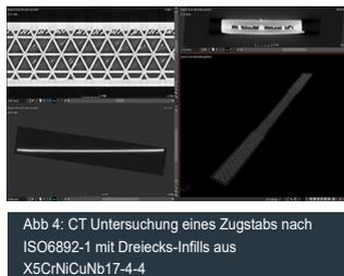
Abb 4: CT Untersuchung eines Zugstabs nach ISO6892-1 mit Dreiecks-Infills aus X5CrNiCuNb17-4-4
