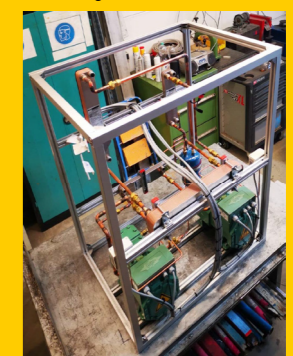
Kälteanlage im Bau
