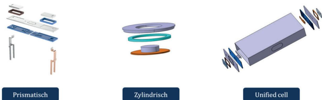
Abb. 1: Deckelbaugruppe für versch. Zellformate
