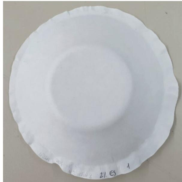
Abb. 3: Papierprobe mit 4% Chitosan
