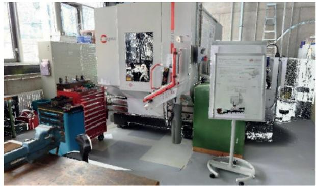
Abb. 2: Punktwolkenscan eines Bearbeitungszentrums mit Farbüberlagerung
