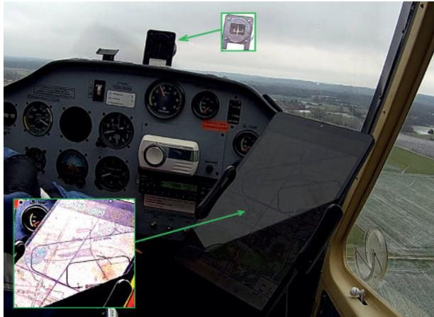
Abb. 2: App-Kartendarstellung ermöglicht genaue Flugpfad-Einhaltung, anders als „Wackelkompass“
