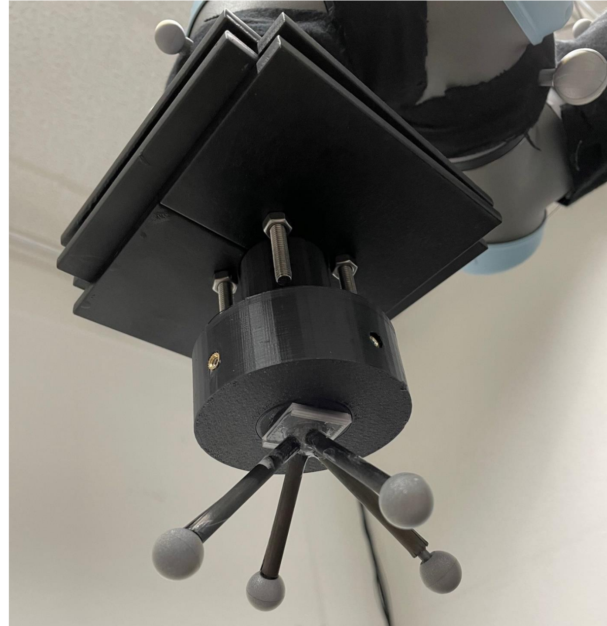
Fig. 2: Endeffektor mit Stahlplatten.
