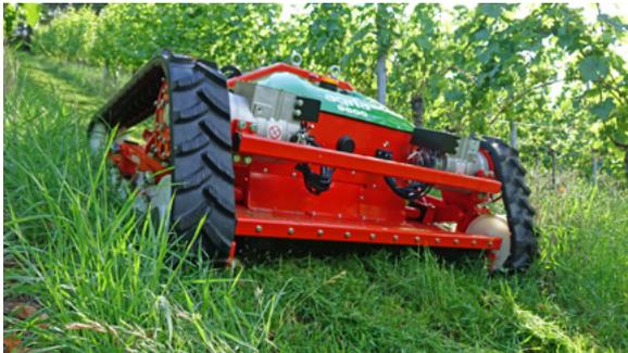
Prototyp des teilautonomisierten Weinbauroboters
